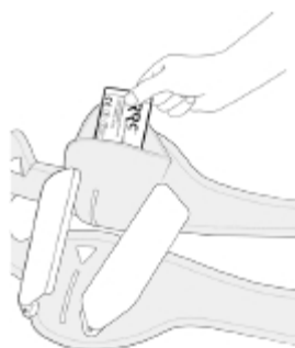
Accès à la batterie
