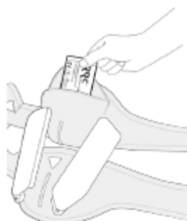
Zugang zur Batterie
